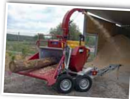
Figure : HH 520 / 30 D Grâce à son organe de roulement aux essieux tandem homologués pour la marche routière jusqu'à 80 km/h (de série), le modèle HH 520 / 30 D se laisse rapidement transporter d'un lieu à l'autre. Une couronne d'orientation entre le châssis et la machine permet de la tourner autour de 300° et de la diriger dans la position de travail souhaitée.
